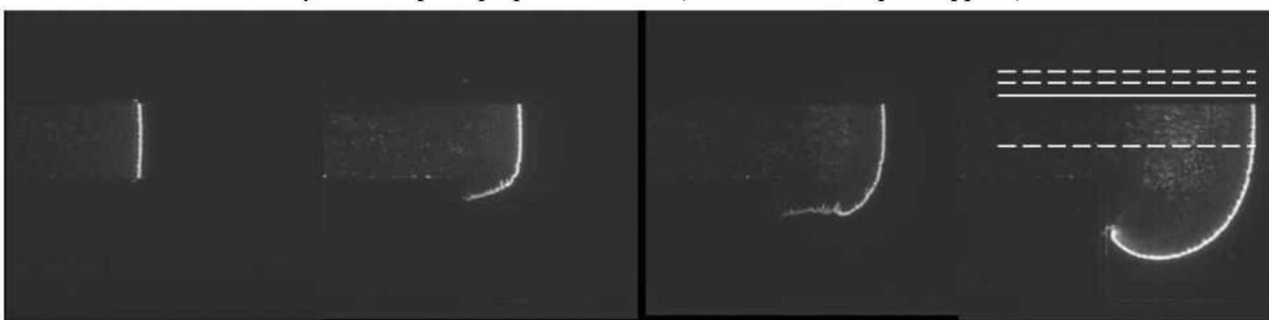
Рисунок 2. Пример восстановления детонационной волны при дифракции.
