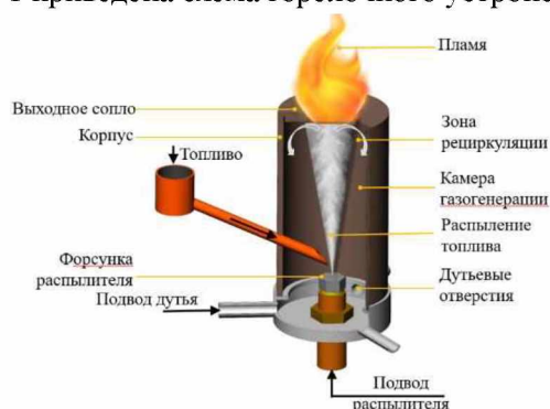
Рис. 1. Схема распылительного горелочного устройства с принудительной подачей первичного дутья.
