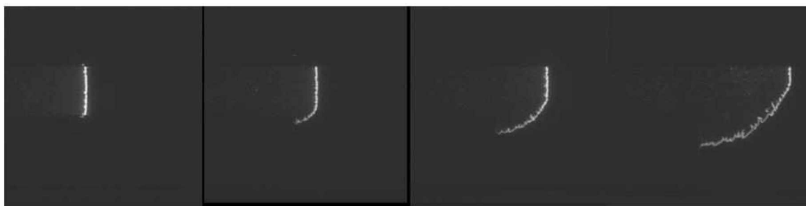
Рисунок 1. Пример срыва детонационной волны при дифракции.
