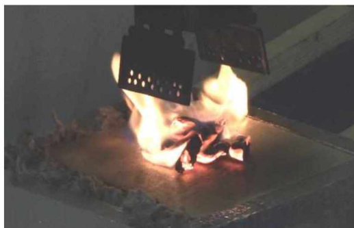
Рис. 1. Фотография эксперимента по взаимодействию группы горящих частиц с образцом древесины сосны
